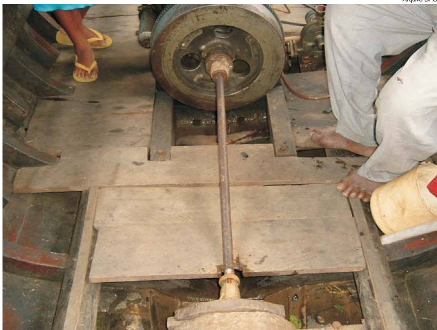
Barco de ribeirinho com motor sem proteção
